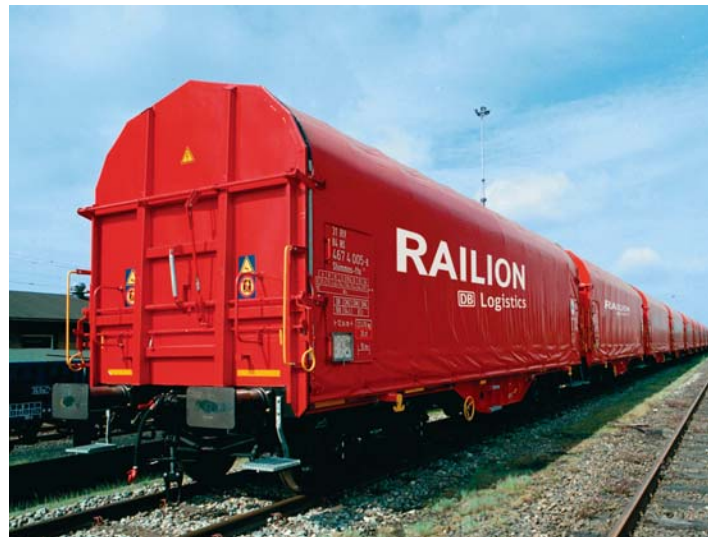
In den Drehstellwagen der Bauart Shimmms können jeweils fünf Stahlcoils sicher vor Witterungseinflüssen gefahren werden
