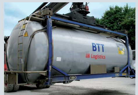
Ideal für Chemietransporte im Kombinierten Verkehr: Großvolumige SWAP-Container von BTT
