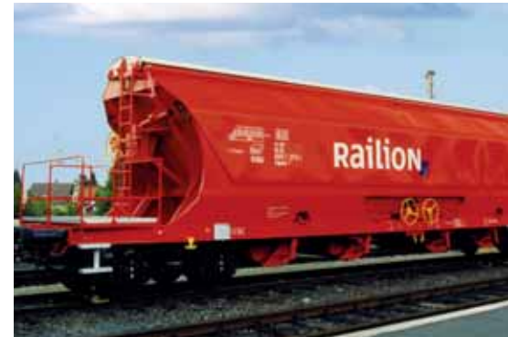
Der Lebensmittelwagen der Bauart Tagnoos 898 eignet sich durch eine rostfreie Innenauskleidung aus Stahl und die tief liegende Mittenentladevorrichtung hervorragend für den Transport von Zucker
