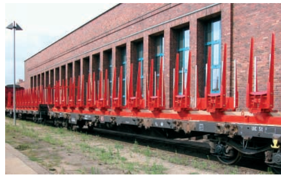
Durch den Umbau besitzt der Flachwagen der Bauart „Res“ ein deutlich höheres Ladevolumen
