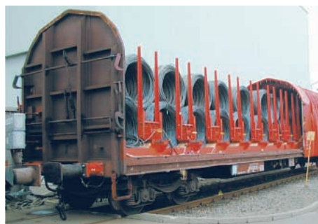
Der Planhaubenwagen der Bauart „Rilns“ wird für besonders nässeempfindliche Drahtrollen eingesetzt
