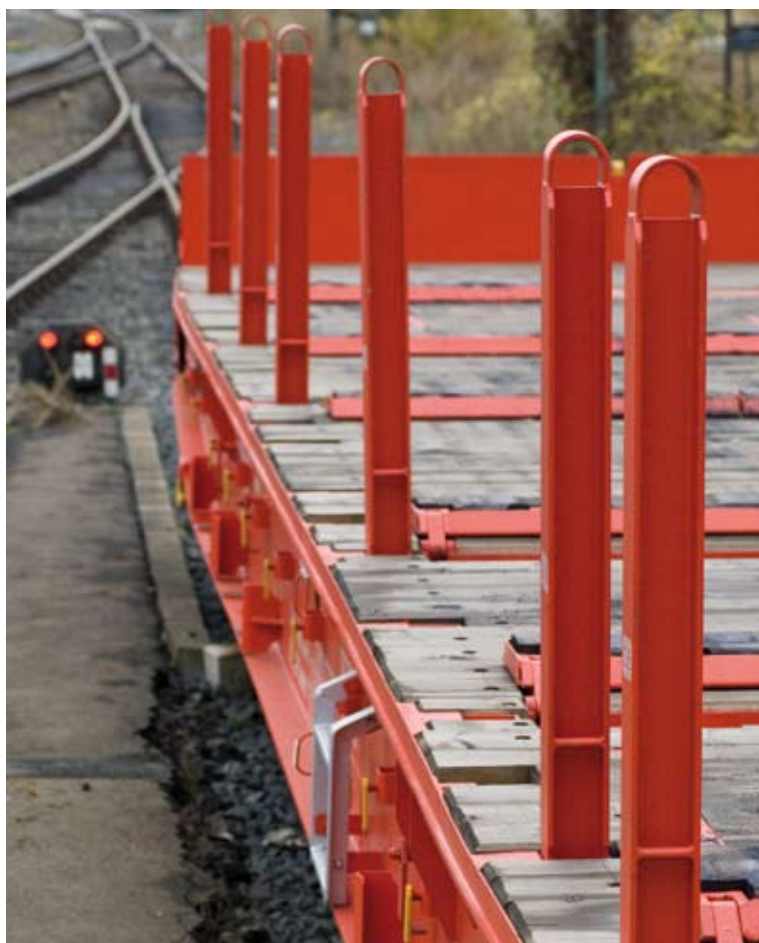
Zu den Eigenschaften des neuen Flachwagens gehören zusätzliche Rungenschächte, die eine variable Positionierung der Rungen erlauben
